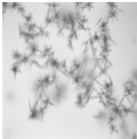
ARAGONITNA OBLIKA VODNEGA KAMNA POD MIKROSKOPOM PO UPORABI KINETIC REACTORJA NA PIPI.
